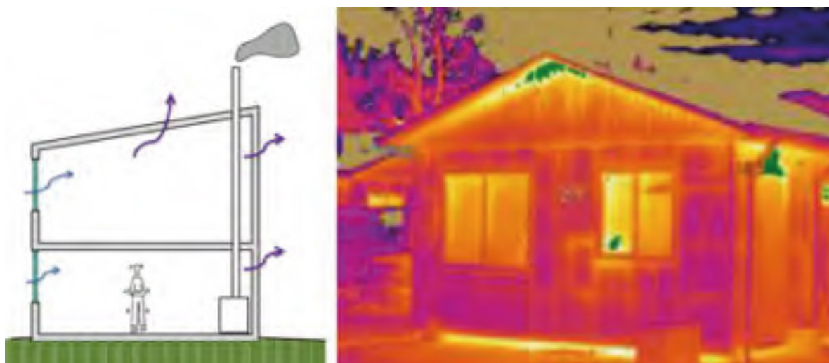
Figura 5. A la izquierda se observa el problema de las infiltraciones. Una vivienda con un alto estándar constructivo debería tener menos de 1 recambio de aire por hora, mientras que en la realidad esto varía entre 12 y 37.
